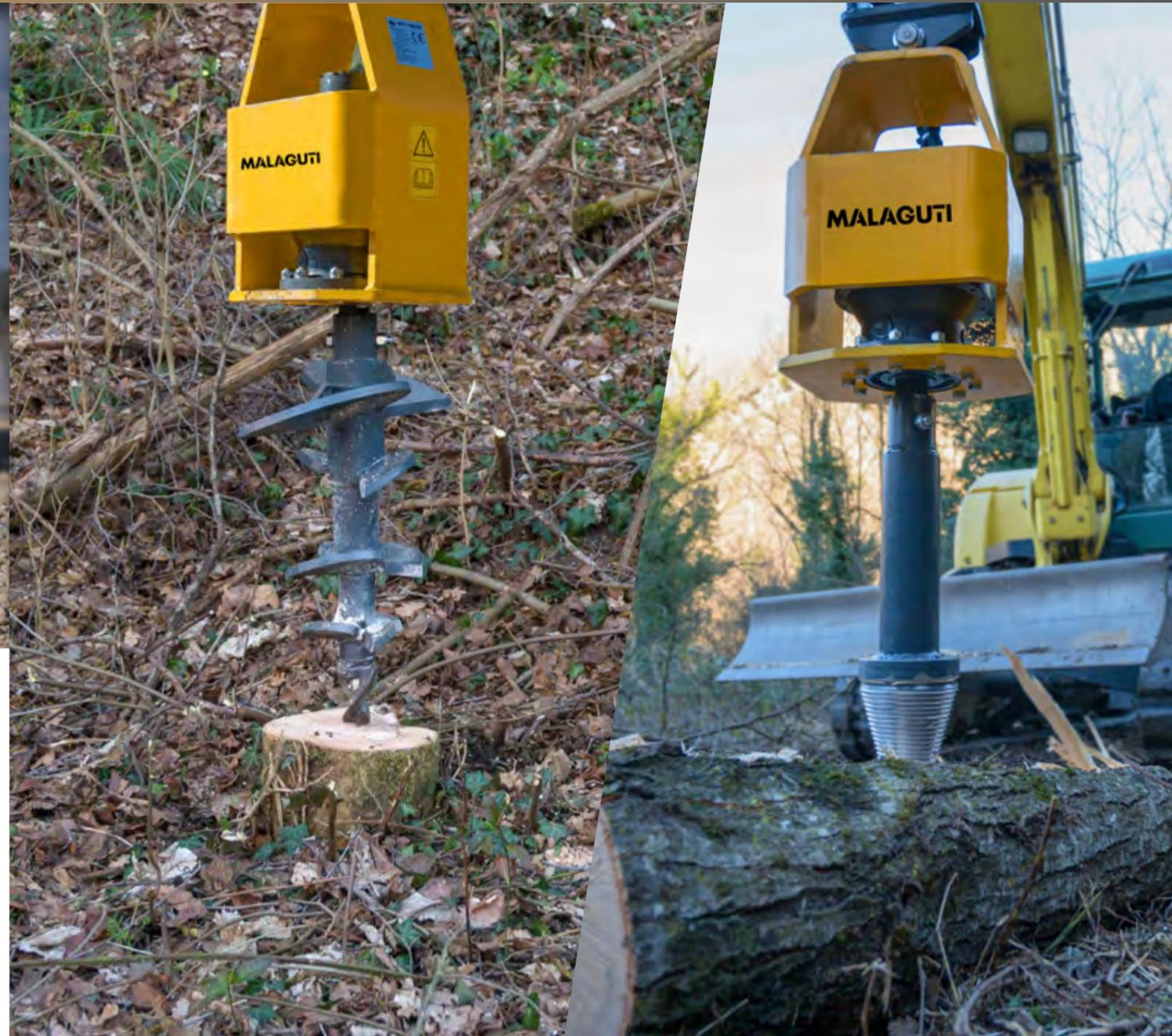
DER ROBUSTE, LEISTUNGSSTARKE ERDBOHRER KANN MIT UNTERSCHIEDLICHEN BOHRWERKZEUGEN UND VERLÄNGERUNGEN AUSGERÜSTET UND DAMIT FLEXIBEL EINGESETZT WERDEN, VOM BOHREN VON ERDLÖCHERN BIS ZUM ZERTRÜMMERN VON WURZELN UND BAUMSTÜMPFEN. DIE AUSRÜSTUNG KANN MIT EINER EINZAPFEN- ODER EINER FIXEN KUPPLUNG GELIEFERT WERDEN.
