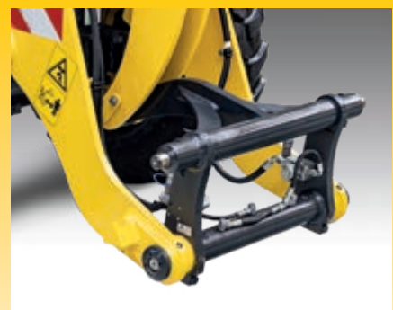
Elektrisch betätigter Schnellwechsler für schnellen und einfachen Anbaugeräte-wechsel
